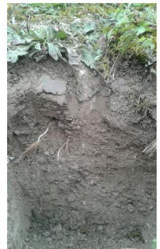
Un test de décantation du sol a été réalisé : il indique une composition de 75% de sable et 25% de limon ; l'argile ne se retrouve qu'en trace. Ce qui confirme son côté perméable.
